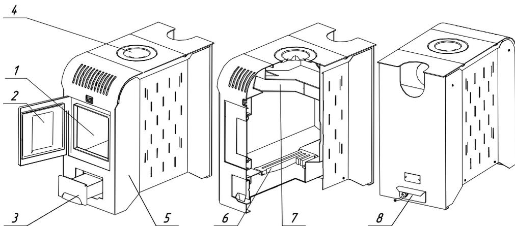
**Рис. 1****Конструкция отопительной печи «МЕТЕОР-150»**
